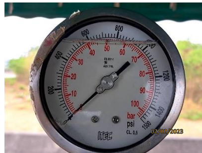
รูปที่ 2-34 การปรับลดแรงดันจากการทดสอบท่อด้วยวิธี Hydrostatic Test
