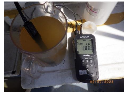
รูปที่ 2-32 การติดตามตรวจสอบคุณภาพน้ำทิ้งจากการทดสอบท่อด้วยวิธี Hydrostatic Test
