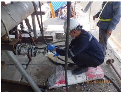
รูปที่ 2-32 การติดตามตรวจสอบคุณภาพน้ำทิ้งจากการทดสอบท่อด้วยวิธี Hydrostatic Test
